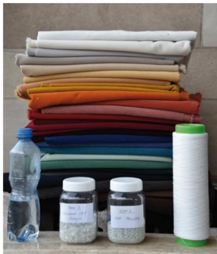
Per ottenere dai filati in PET riciclati un materiale leggero e morbido, senza compromettere la brillantezza dei colori, è stato necessario un approccio altamente innovativo. Grazie a ulteriori ricerche è stato inoltre possibile rendere il tessuto ignifugo.
